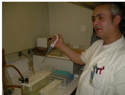
Слика 11. Припрема узорака чврсто-фазном екстракцијом (SPE)
